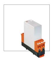
Der PROFIBUS Terminator bildet einen aktiven Busabschluss. Der wesentliche Vorteil liegt darin, dass Busteilnehmer abgeschaltet, entfernt oder ausgetauscht werden können, ohne dass der Datentransfer beeinträchtigt wird. Dies gilt besonders für die Busteilnehmer an beiden Enden der Busleitung, an denen bisher die Abschlusswiderstände zugeschaltet und versorgt sein mussten.
