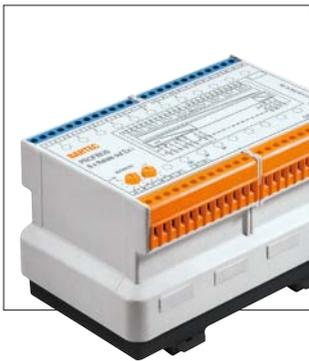
Das MODEX 8 x Relais out Modul kann über 8 Ausgänge in Ex i-Ausführung verschiedene Aktoren schalten. Es können zum Beispiel eigensichere Magnetventile oder andere eigensichere Stromkreise direkt geschaltet werden. Das Modul wird über PROFIBUS-DP mit dem Prozessleitsystem verbunden. Für die Adressierung des Moduls stehen Codier-Drehschalter zur Verfügung.
