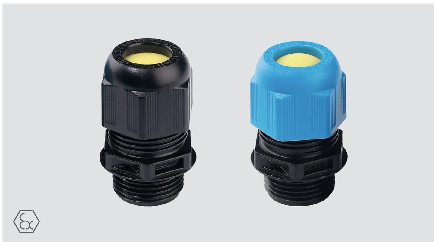
Die Kabelverschraubung aus Polyamid, dient zur Einführung festverlegter Kabel und Leitungen in elektrische Betriebsmittel der Zündschutzart Erhöhte Sicherheit „e“. Die Kabelverschraubung entspricht der Schutzart IP 66/68.
