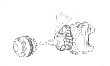
Montage des ComEx Ex i Leuchtmodul für Tragschienenmontage:
