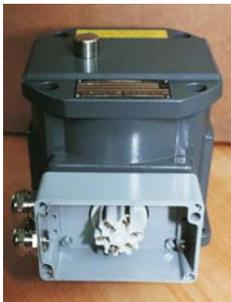
Face de raccordement d'une traversée à bornes
