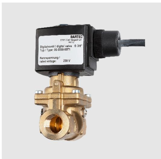
A válvula digital de gás de purga comuta o abastecimento de gás de purga. É uma válvula solenoide operada por piloto usada para introduzir gás de purga em um invólucro pressurizado na zona 2.
